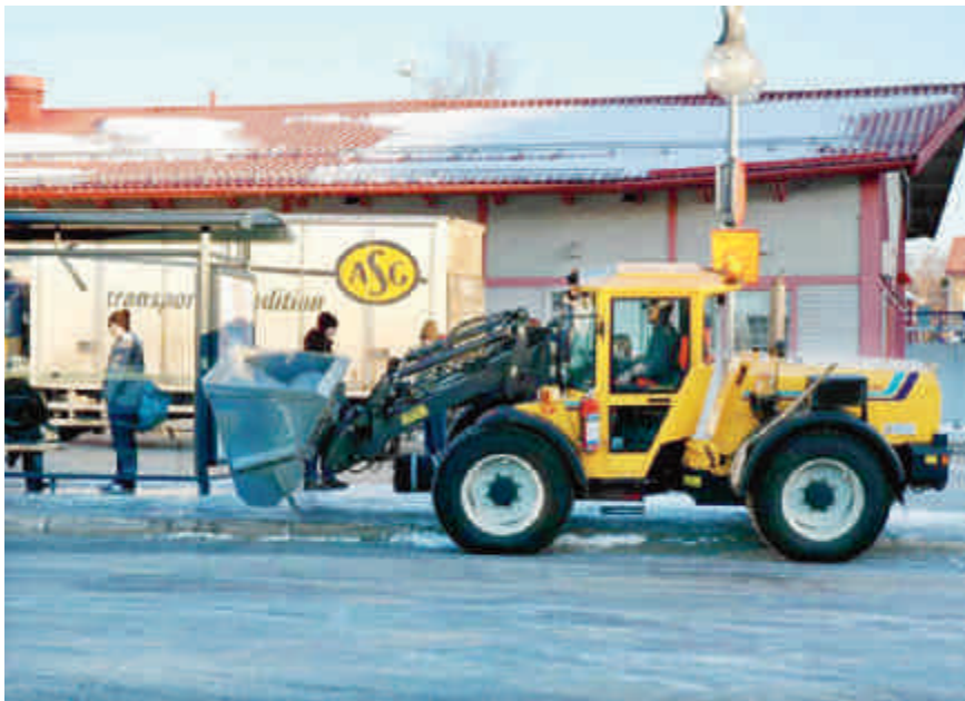
Sandning av busshållplats. Foto: Skellefteå kommun
