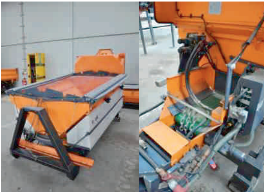
Påbyggnadsutrustning för spridning av befuktat salt. Foto: Claes-Anders Malmberg
