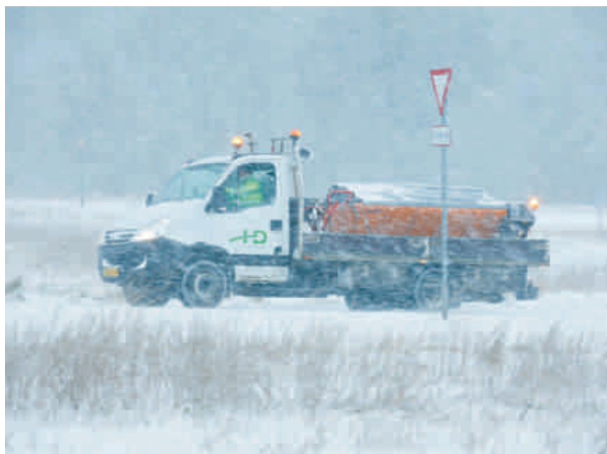
Bil med påbyggnadsutrustning för befuktat salt ifrån Danmark. Foto: Thomas Randrup .
