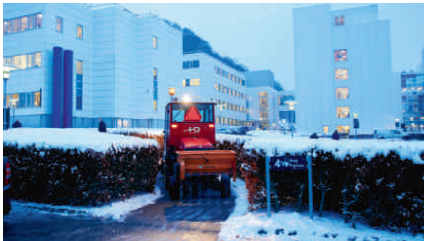
De bogserade spridarna kan sprida från 1,5–6 meter och används därför på lokalgator och cykelvägar. Foto: Thomas Randrup .
