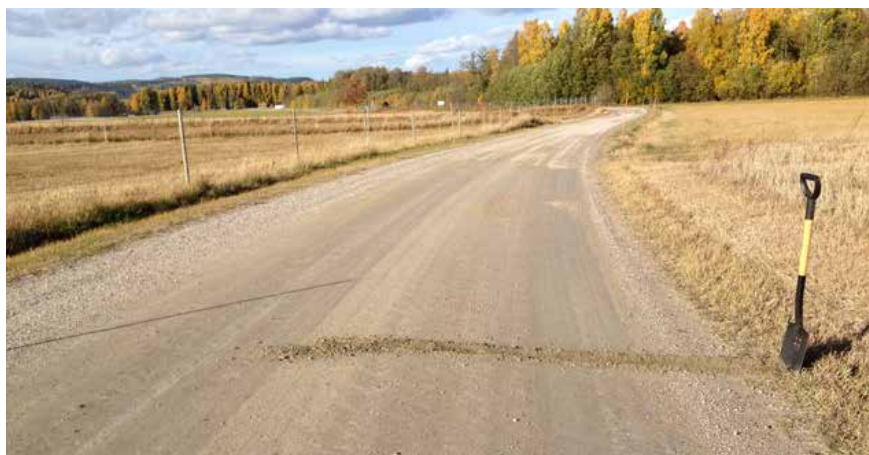
Provtagning av gruslitlager ute på väg. Foto Karin Edvardsson.
